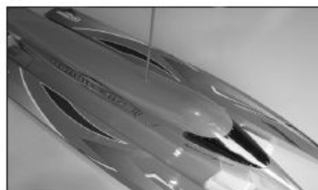
18. Проденьте антенну через палубу и установите палубу на место. Магниты служат для крепления палубы и быстрого доступа к агрегатам.
