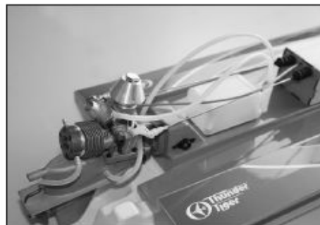
15. Обратитесь к руководству по двигателю, для подключения топливо-провода. Убедитесь, что топливо-провод не цепляется при поворотах двигателя.
