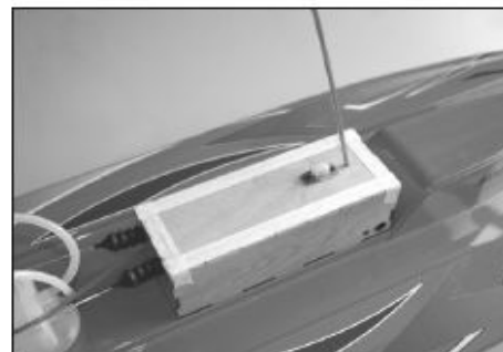
16. Вставьте антенну в антенную трубку, затем вставьте её в радио отсек. Используйте клей для фиксации
